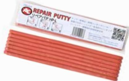
凹凸や継ぎ目の段差がある場合やエア、水圧が0.6Mpa以上の場合には減圧または停止させてから下地にリペアパテを必要な大きさに切って貼り付け滑らかにし、その上からリペアテープを巻きつけてください。部品成型用の型取りとしても使用できます。リペアパテの性状はリペアテープと同じです。
